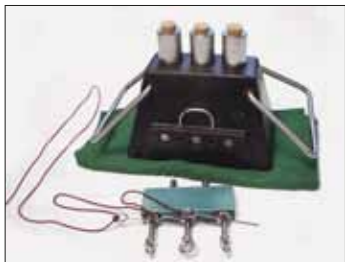
Abb. 22: Dreirohriger Standböller mit mechanischer Zündung und Abzugsleine
